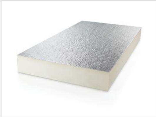
sind Wärmedämmplatten aus PU-Hartschaum mit strukturierter Reinaluminiumfolie beidseitig und gerader Stoßkante. Nut/Feder gegen Aufpreis möglich. Andere Stärken auf Anfrage. steinothan® 107 findet Anwendung auf Dächern mit Folien oder Bitumenabdichtung (mit oder ohne Auflastung)
