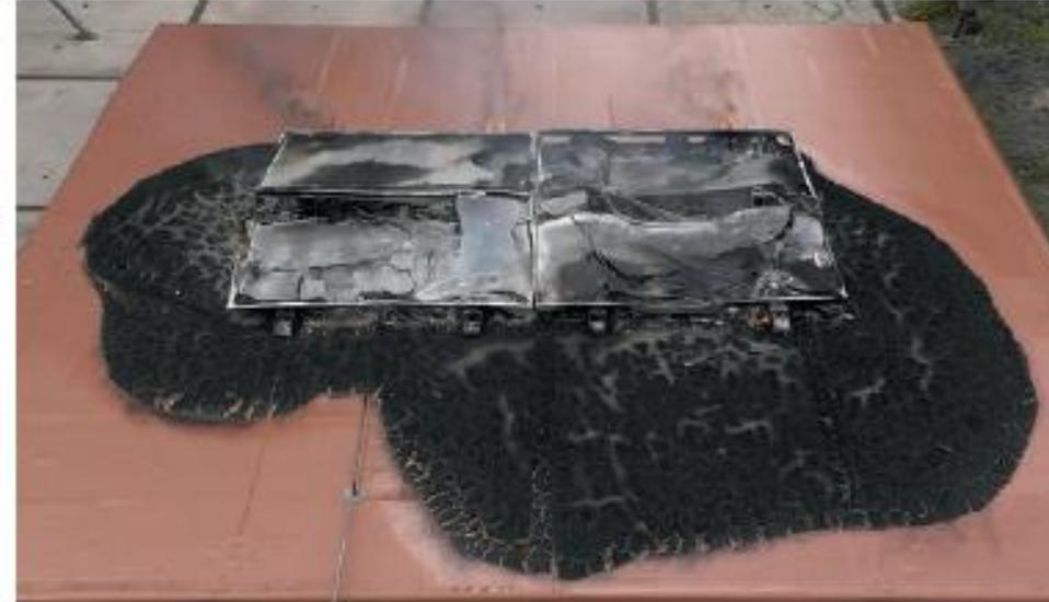
Bild 4 | MW-Dach mit PV-System nach dem Brandversuch
