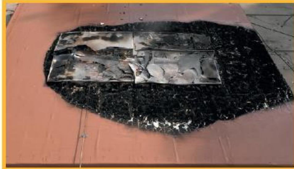
Bild 3 | PU-Dach mit PV-System nach dem Brandversuch
